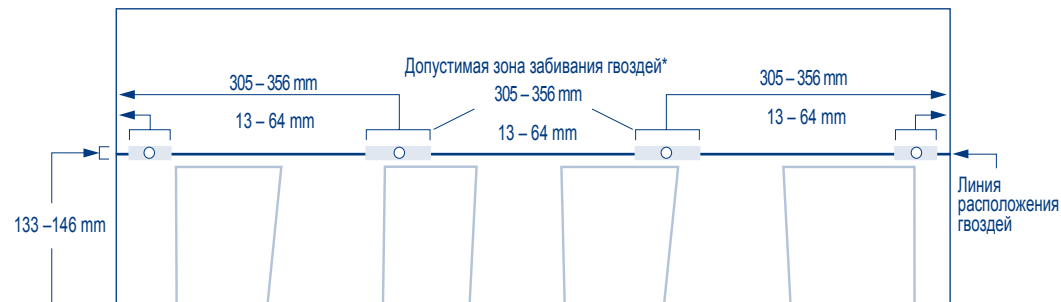
Схема крепления четырьмя гвоздями
