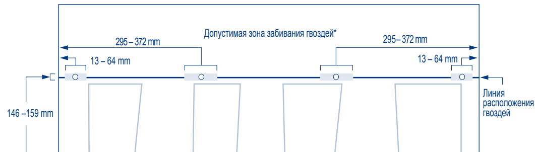
Схема крепления четырьмя гвоздями
