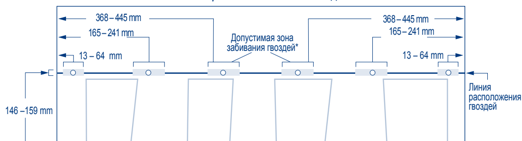
Схема крепления шестью гвоздями
