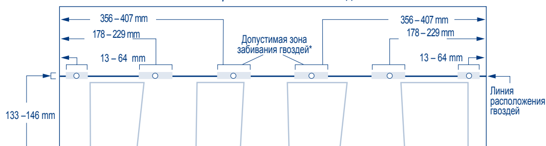
Схема крепления шестью гвоздями
